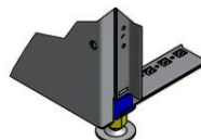
Detail B Anreihverbinder mit Seitenwand
